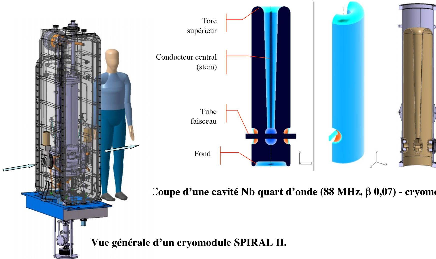
Coupe d'une cavité Nb quart d'onde (88 MHz,  $\beta$  0,07) - cryomodule A.
